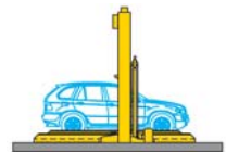
Înainte de coborârea platformei superioare, trebuie scos autoturismul aflat pe platforma inferioară
